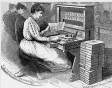
Обработка данных проводилась с помощью электрической машины Голлерита.
